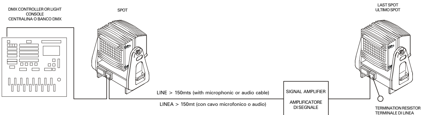
EXAMPLE 2/ESEMPIO 2 Connection controller-spot to one DMX 512 OUTPUT over 150mts long Collegamento centralina-spot ad una sola LINEA DI USCITA DMX 512 lunga oltre 150mt.
