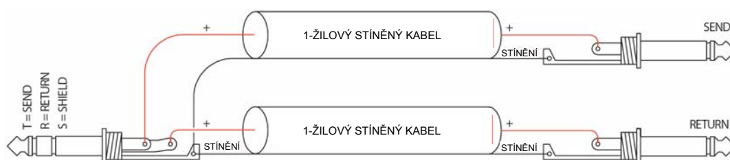
Zapojení insertového kabelu ("Y") pro efektovou smyčku
