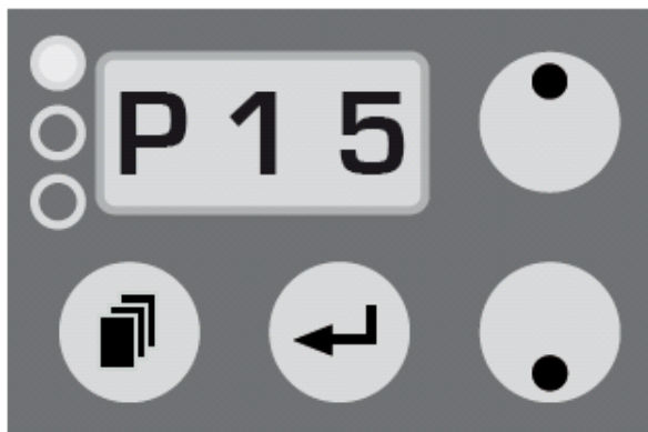
Nastavení čerpadla (v krocích 1-99%)
